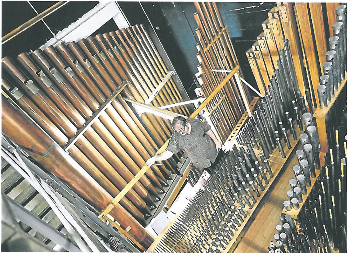
Ein Blick in das Innenleben der Orgel in der Rhein-Mosel-Halle, wo Mitarbeiter der saarländischen Firma Mayer derzeit die Pfeifen einbauen und stimmen. Die größten sind mehr als fünf Meter, die kleinsten Pfeifen hingegen nur wenige Zentimeter lang.
